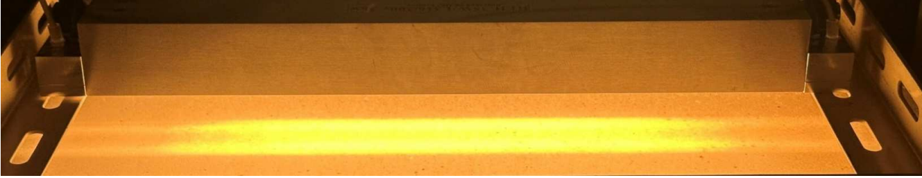
HLH-35W/f∞/L316 ฉายรังสีอิฐทนไฟจากระยะ 30 มม
